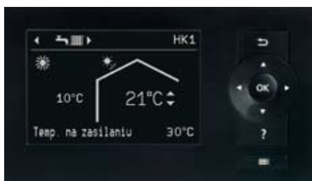
Wyświetlacz regulatora pompy ciepła Vitotronic 200
